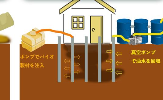
汚染箇所が掘削除去不可能な箇所においては、汚染箇所に有孔管を打ち込み油除去剤循環による洗浄や炭化水素分解菌で浄化作業を行ないます。
