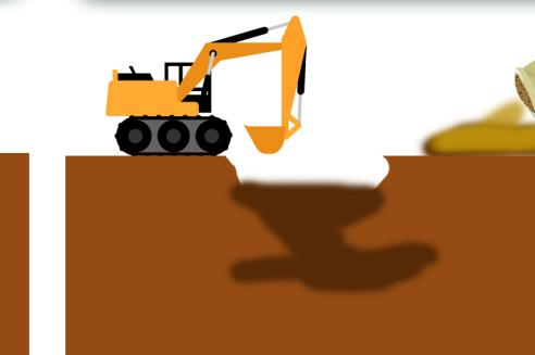
敷地内にスペースが確保可能で埋め戻しまでの間に余裕がある場合には掘削した汚染土を別の場所に掘り上げバイオ製剤を使用し浄化し、浄化完了後に再生土にて埋め戻します。
